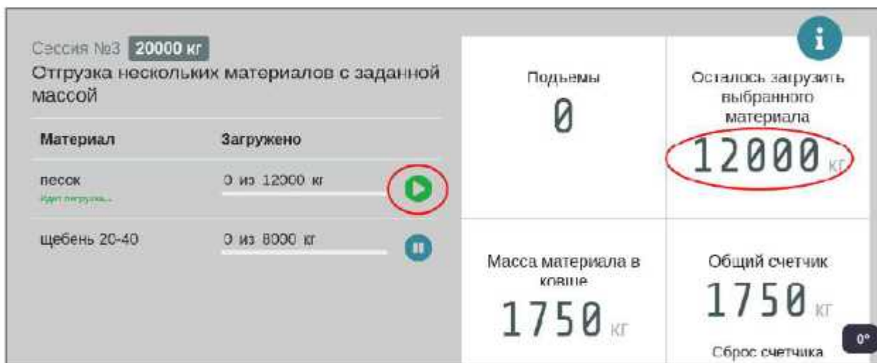
Рис. 71. Показания терминала ВТЦ в режиме отгрузки нескольких материалов
