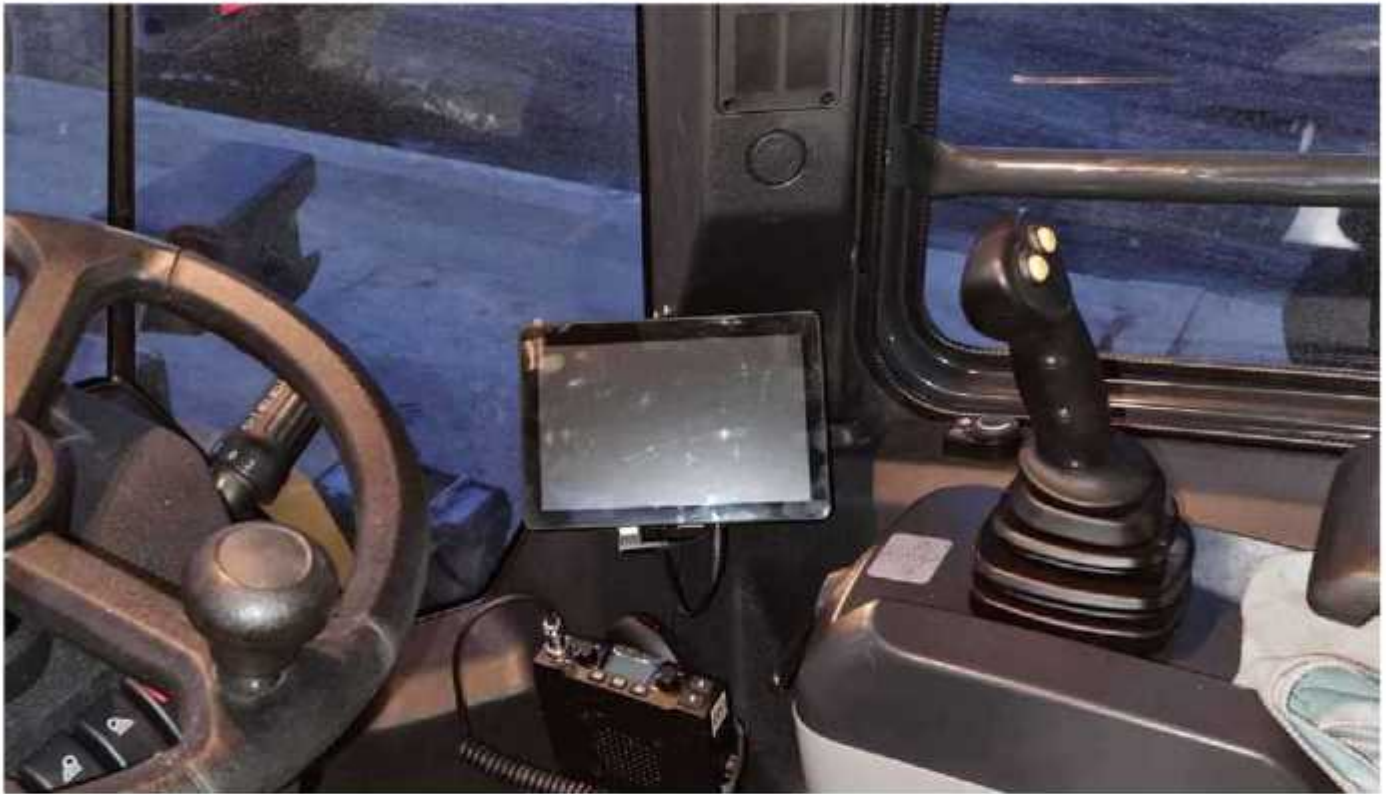
Рис. 8. терминала ВТЦ установленный в кабину погрузчика
