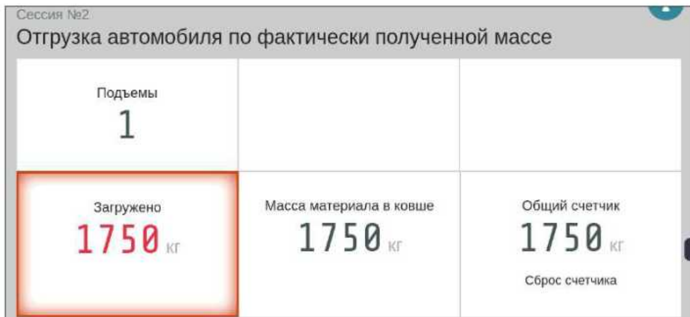
Рис. 69. Показания терминала ВТЦ в режиме отгрузки по фактической массе
